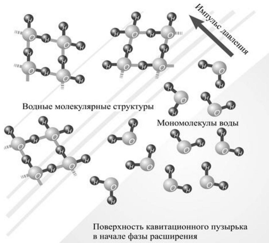
Рис. 1. Разрушение надмолекулярной структуры воды кавитацией
