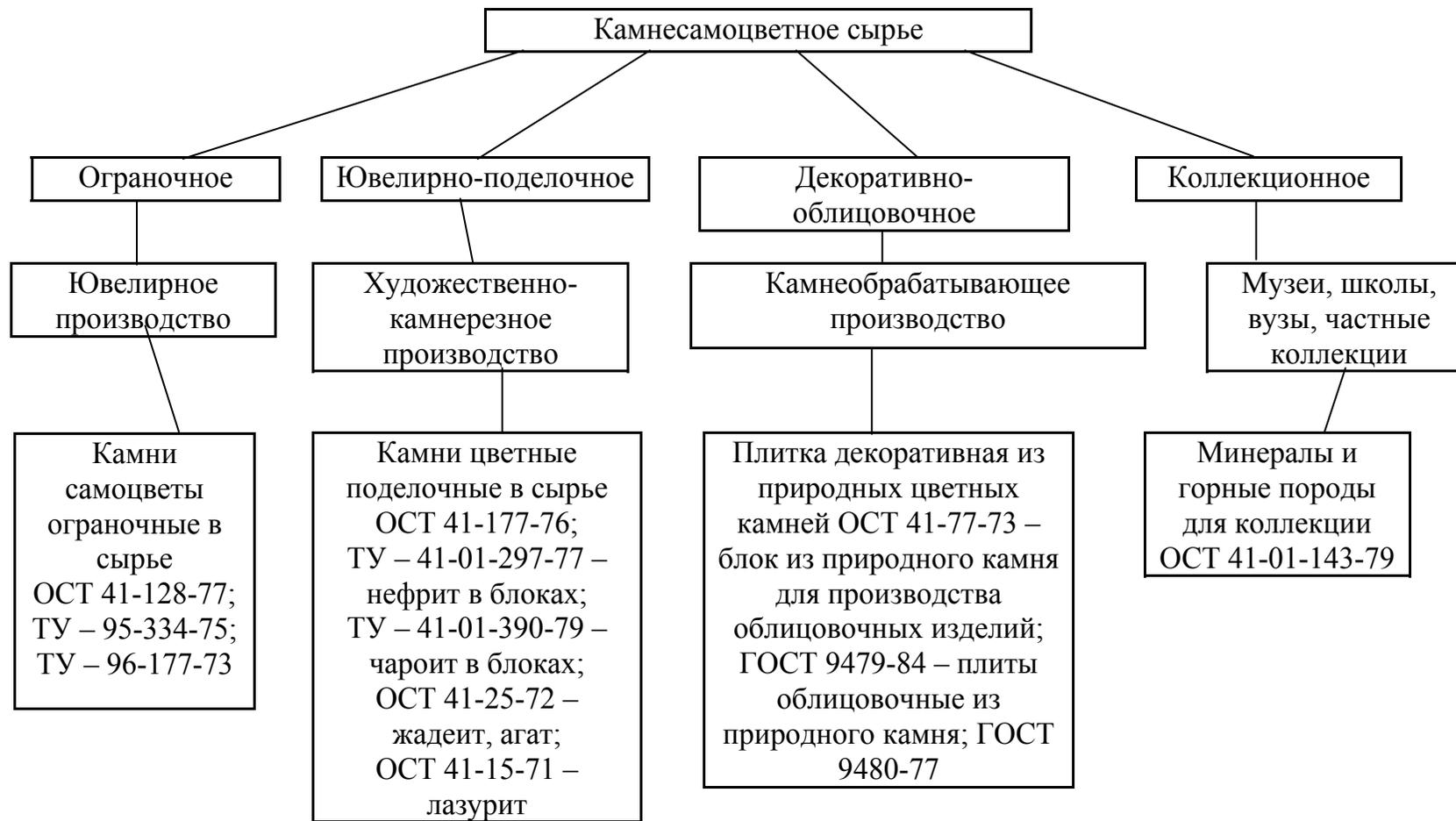
Рис. 1. – Классификация камнесамоцветного сырья по его использованию
