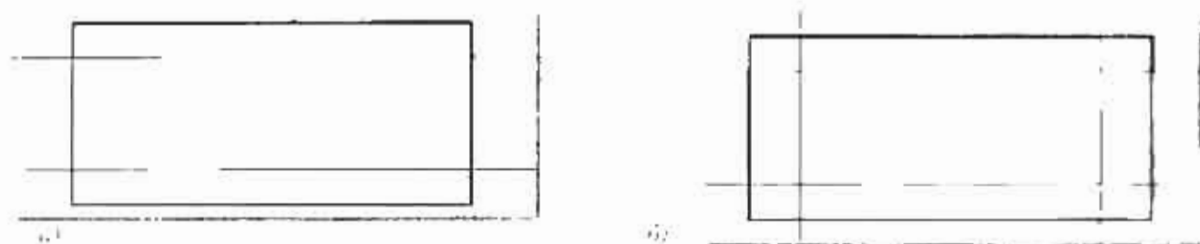
Рис. 8.21. Построение конструктивных линий
